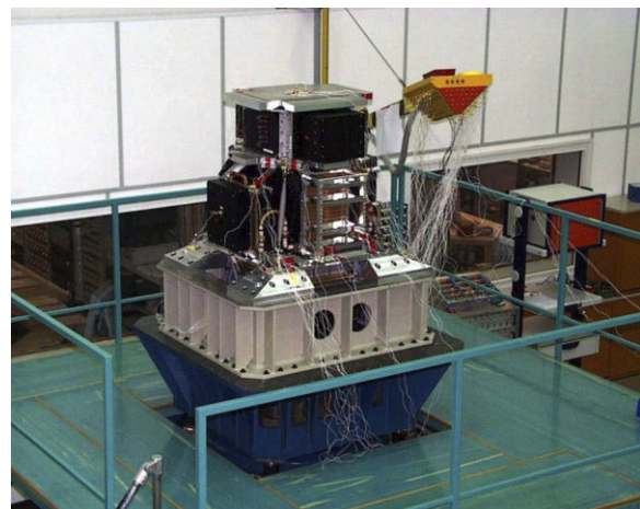
Fig. 21. The PAMELA MDTM on the shaker system in IABG (August 2002).
